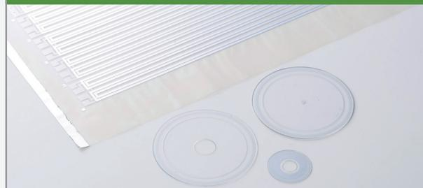
各種基材に蒸着加工した金属薄膜を化学的にエッチングし、パターンを形成。ITO / アルミニウム / 硫化亜鉛やニッケルなどをスパッタ・蒸着した薄膜素材にエッチング加工を行い、精度の高いパターンを実現。
