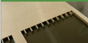
ワイヤー放電加工とエッチングの複合技術による部品提供を実現。
